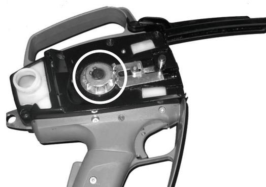
**⚠ PRÜFEN SIE, DASS DER SICHERUNGSRING IN DER NUT LIEGT.**
