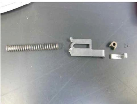
**⚠ SOBALD DER TRUARCRING ENTFERNT IST, KANN DAS AUTOMATISCHE KETTENSANSPANNUNGSSYSTEM JEDERZEIT HERAUSSPRINGEN. VERLETZUNGSGEFAHR ODER VERLUST VON TEILEN.**
