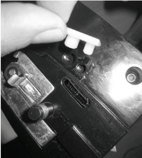
Setzen Sie mit der Hand eine neue Kettenführung ein. Achten Sie dabei auf die richtige Richtung. (Siehe Größe der Öffnungen im Gehäuse)
