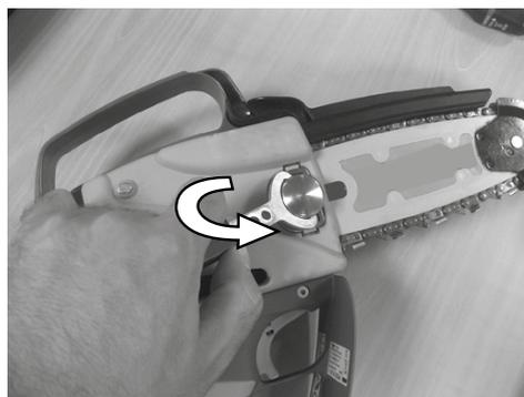
3- Jetzt ist es möglich, die Kettenabdeckung zu entfernen. Diese zunächst neigen (2) und dann abnehmen (3).
