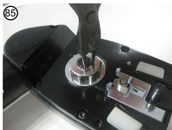
Setzen Sie am Rand des Kopfs den Greifhaken (86) ein und ziehen Sie die Schraube an, um ihn zu befestigen.
