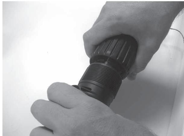
Das Außenrohr vom Innenrohr trennen.
