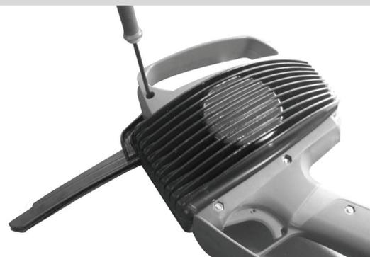
63- Die beiden Kettengleitstücke mit der Hand einsetzen.
