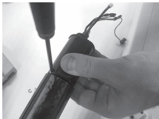
Den Sicherungsstopfen ganz in das Innenrohr einführen.
