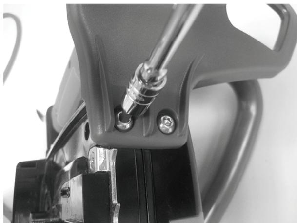
Entfernen Sie die erste Schraube des seitlichen Griffs.
