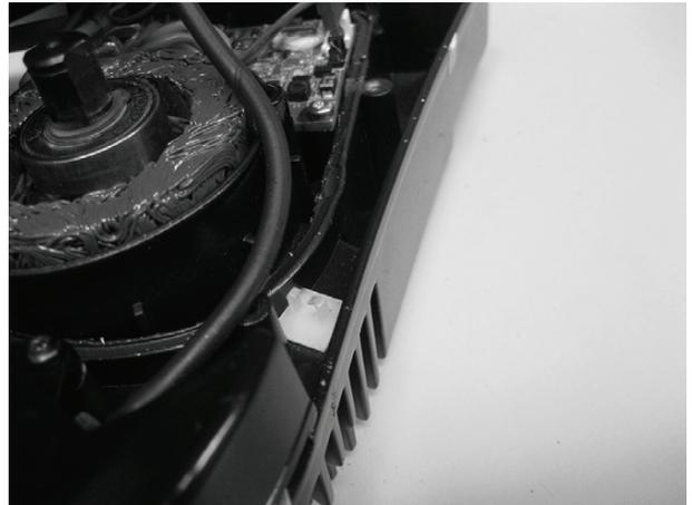
Schließen Sie die beiden Gehäusehälften und setzen Sie die 5 Befestigungsschrauben ein und ziehen Sie diese fest.
