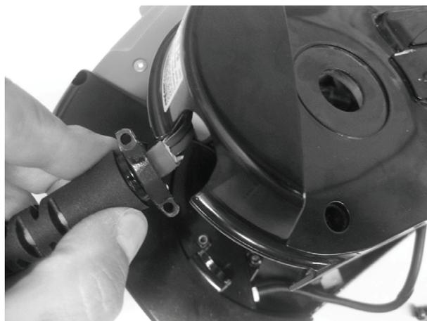
Ermitteln Sie in der rechten Gehäusehälfte den Haltering und heben Sie die Lasche leicht an, um die Leiter freizulegen.
