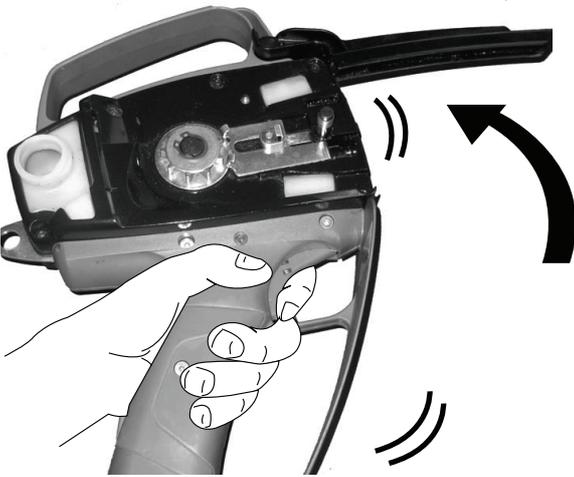
Dieses Verfahren wird ohne Kettenführung und Kette ausgeführt.
