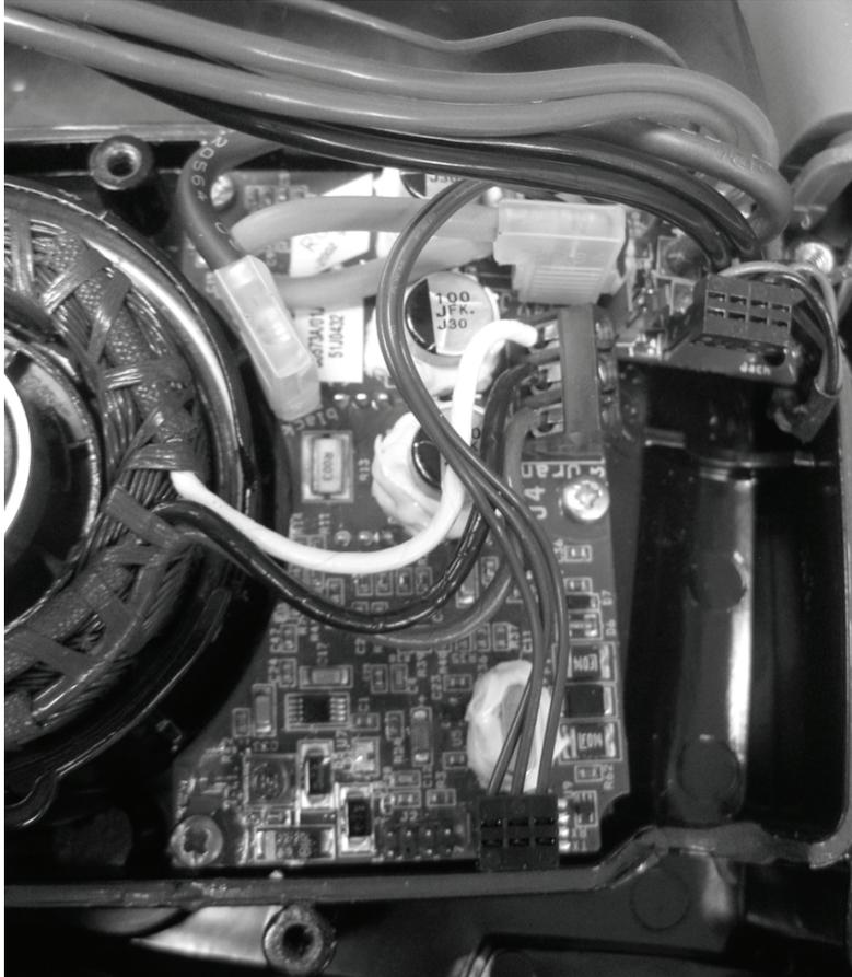
Klemmen Sie die beiden Kabelschuhe der Stromversorgung wieder an: Zuerst den schwarzen Leiter (41), dann den roten (42).
