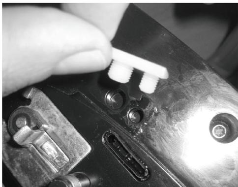
Setzen Sie mit der Hand eine neue Kettenführung ein. Achten Sie dabei auf die richtige Richtung. (Siehe Größe der Öffnungen im Gehäuse)
