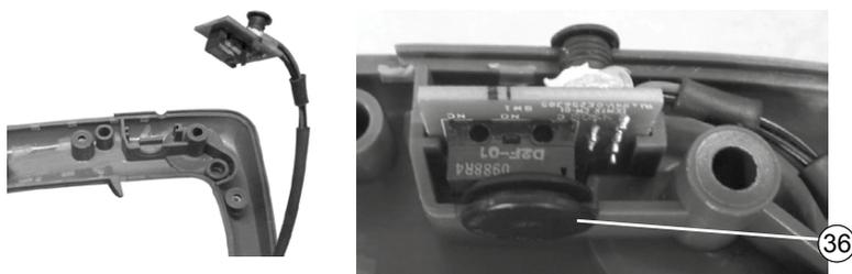
Setzen Sie die Bedienhebelelemente wie unten dargestellt in die linke Gehäusehälfte ein.
