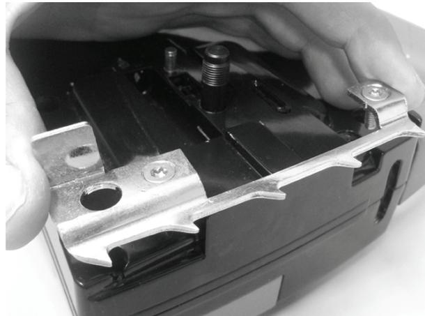
Ziehen Sie die 2 Befestigungsschrauben des Krallenanschlags an.
