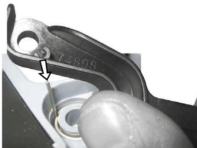
60- Den Federwiderstand überwinden, um den Kettenschutz vollständig in seinen Sitz zu drücken.
