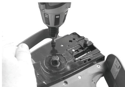
**!** Wird das Gehäuse auf der linken Seite ausgetauscht, muss ein damit kompatibler Griff montiert werden. Siehe Abbildungen hier unten:
