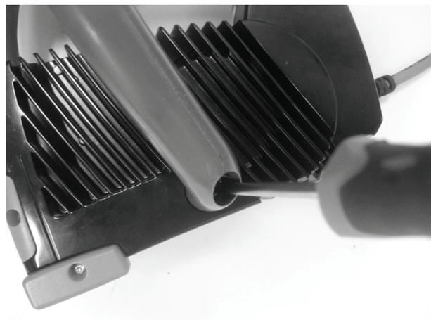
Setzen Sie die zweite Schraube am oberen Griff ein und ziehen Sie diese fest, um den seitlichen Griff vollständig befestigen zu können.
