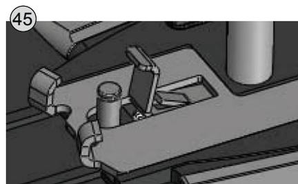
66 - Setzen Sie das Zentrierungsprisma (46) auf die Welle, indem Sie es unter der Sicherungslamelle durchführen, und sichern Sie es mit dem Truarc-Ring (47)
