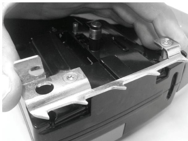
Entfernen Sie die 5 Befestigungsschrauben der rechten Gehäusehälfte.
