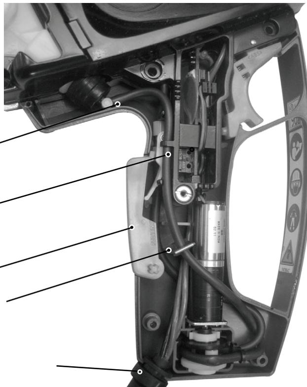
**!** DIE ANORDNUNG ALLER KABEL IST WICHTIG, UM DAS WERKZEUG KORREKT SCHLIESSEN ZU KÖNNEN. VOR DER DEMONTAGE SICH DEN KABELVERLAUF EINPRÄGE.
