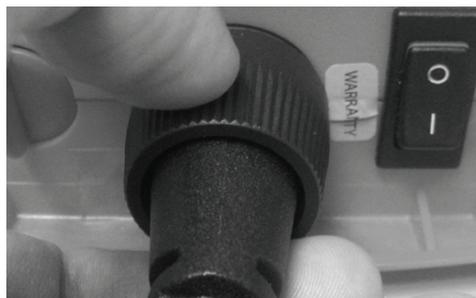
2 - Die Befestigungsschraube der Kettenführung zu sich ziehen und im Gegenuhrzeigersinn drehen, um das Gerät zu entfernen.
