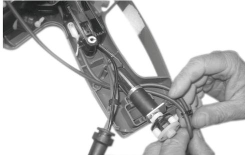
51 - Das Pumpenlager an der Einbaustelle positionieren.
