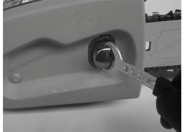
Füllen Sie Öl auf und schließen Sie den Verschluss des Öltanks.
