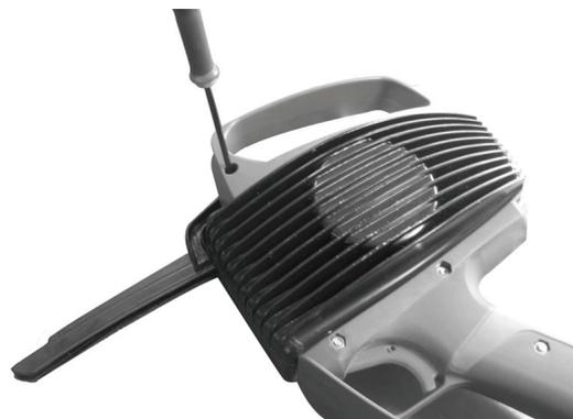
11 - Entfernen Sie auf der anderen Seite den Kettenschutz sowie die Feder und die Welle.
