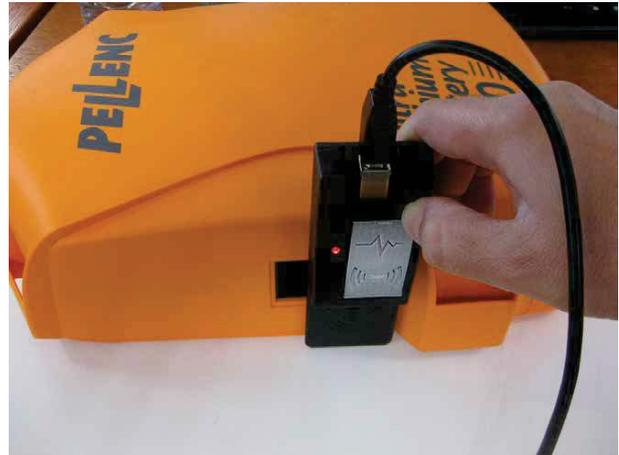
Drücken Sie die Schaltfläche RFID **1** zum Start der Akkuablesung.
