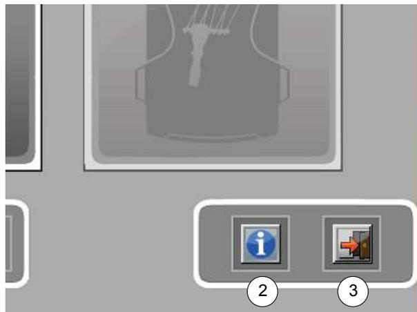
Der Zugriff auf die Parameter erfolgt durch erneutes Positionieren der RFID-Platine gegen die Platine des Akkus und Anklicken der Schaltfläche zum Ablesen der Parameter (oder Druck auf F1) (10 Sekunden Wartezeit)
