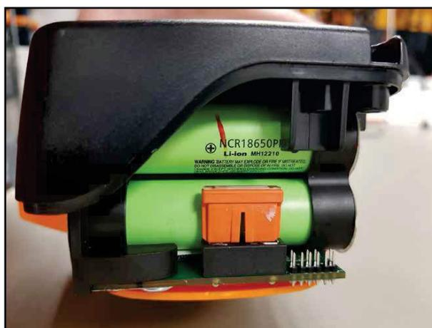
**5.11 - MONTAGE DER PLATINE BEI DEN AKKUS 200 / 250 / 2KW / OLIVION**
