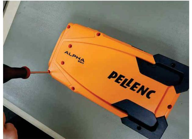
**HINWEIS:** SEHEN SIE DIE ARBEITSANWEISUNGEN ZUM AUSTAUSCH DER PLATINE EIN, UM GENAUERE INFORMATIONEN ZUM ANZIEHEN „ÜBER KREUZ“ DER GEHÄUSESCHRAUBEN ZU ERHALTEN.
