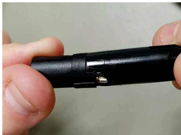
Das Steckervorderteil zur Hand nehmen und den Schnappverschluss ausfindig machen, damit das Vorderteil beim Aufsetzen mit dem Steckerinnenteil übereinstimmt.
