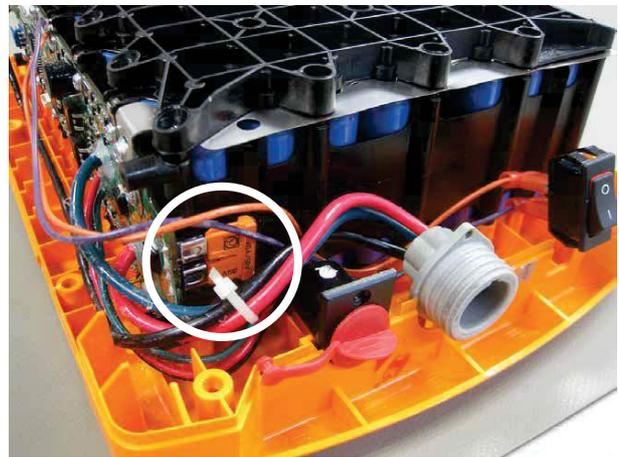
Das obere Gehäuse wieder aufsetzen und die 9 Schrauben wieder einschrauben.
