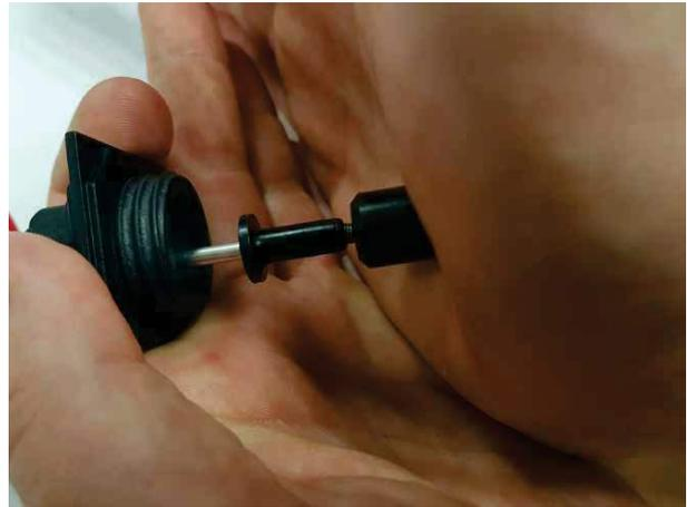
Den gebrochenen Kontakt unten abschneiden, dann die Ader so weit abisolieren, wie es für die Befestigung des neuen Kontakts erforderlich ist.
