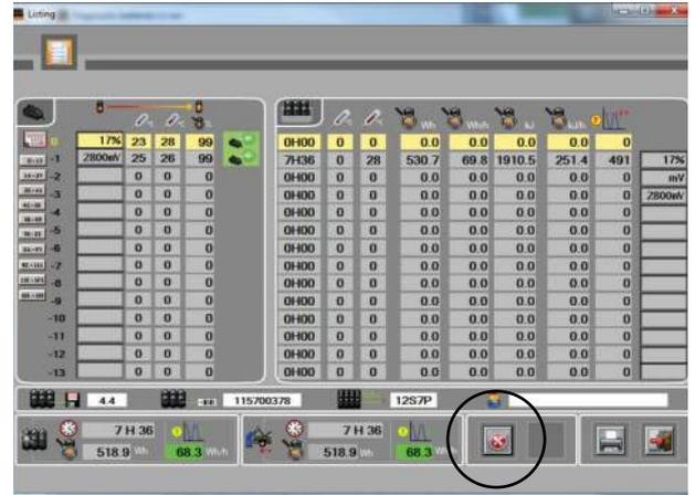
Wenn das Feld 3 mehrfach rot ist, bedeutet dies, dass die Platine ausgewechselt werden muss.
