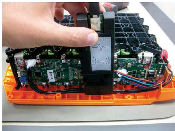
Drücken Sie die Schaltfläche RFID ① zum Start der Erkennung des Akkus.
