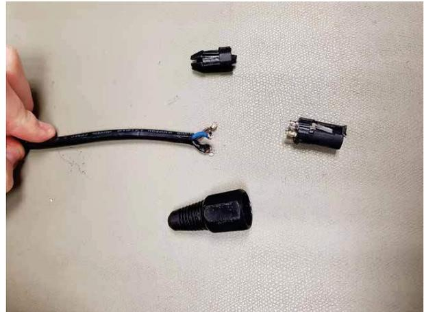
Darauf achten, dass die Adern gemäß der im unten gezeigten Schema angegebenen Werte abisoliert sind. Ist dies der Fall, bitte direkt zu den Anweisungen der nächsten Seite übergehen. Andernfalls die folgenden Anweisungen befolgen.
