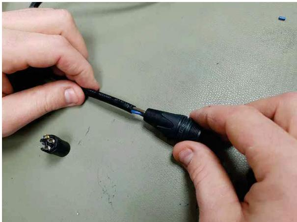
Den Einsatz anbringen, wobei mithilfe des nebenstehenden Fotos zu überprüfen ist, dass die Einbaurichtung korrekt ist.
