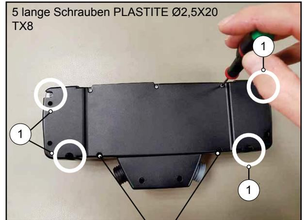
2 kurze Schrauben PLASTITE Ø2,5X16 TX8
