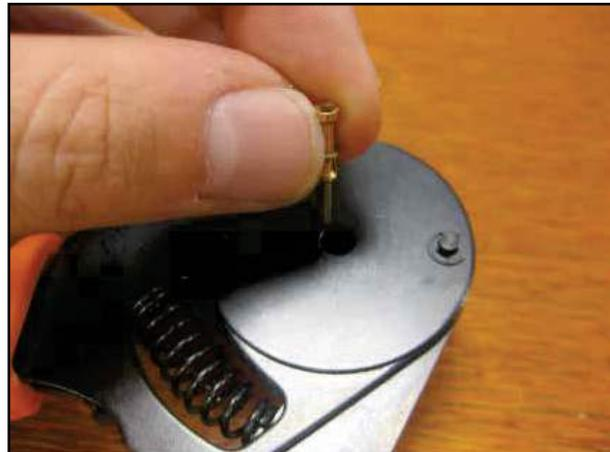
Den mechanischen Anschlag so einstellen, dass der Kontakt mit der Öffnung fluchtet.
