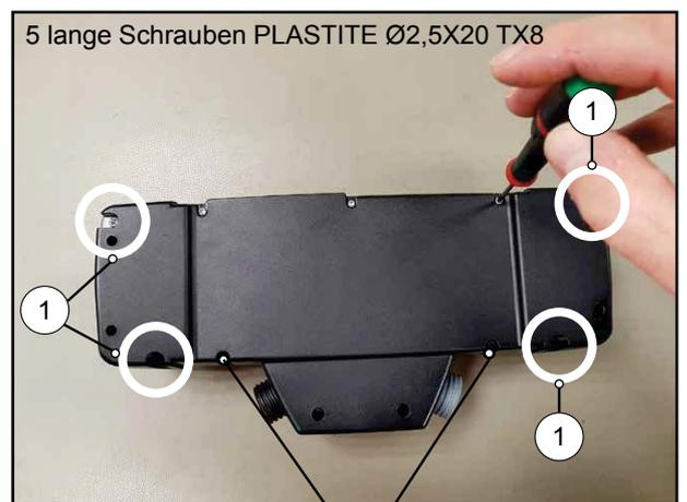
2 kurze Schrauben PLASTITE Ø2,5X16 TX8
