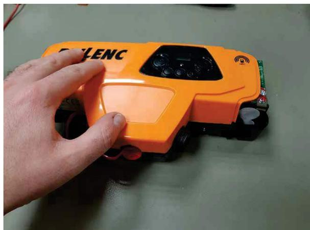
**5.17.4 - LADEGERÄTTESTS MITTELS DIAGNOSE-SOFTWARE - ANSCHLUSS LÖSEN UND AKKU WIEDER ZUSAMMENBAUEN**
