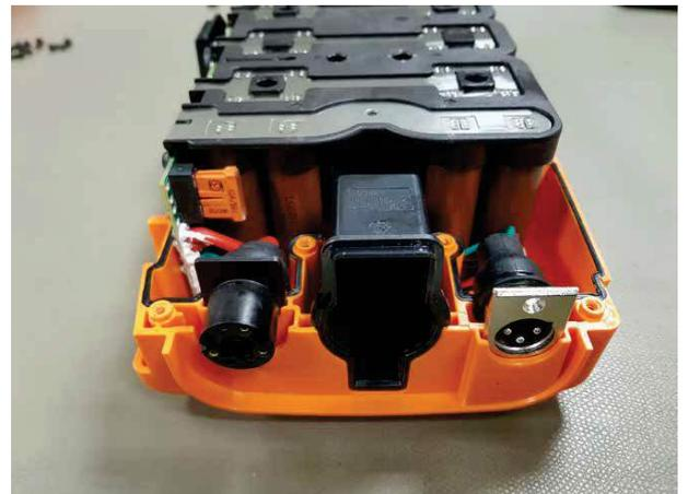
Die Steckverbinder für Ladegerät und Arbeitsgerät ausbauen.
