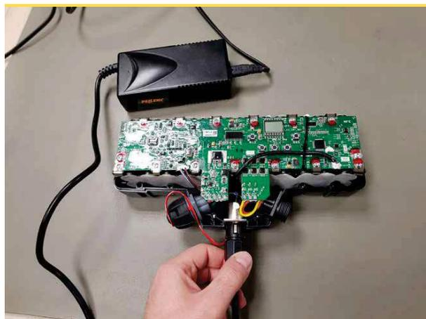
Das IRDA-Modul mittels Verbindungskabel an die Platine anschließen (blauer Steckverbinder an der Platine)
