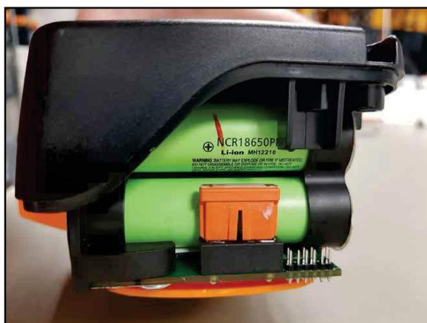
**5.11 - MONTAGE DER PLATINE BEI DEN AKKUS 200 / 250 / 2KW / OLIVION**
