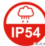
Schutzart des Geräts IP54 (Schutz gegen Staub und Spritzwasser).
