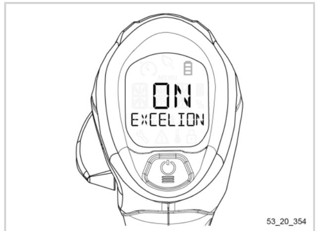
3. Kontrollieren, ob auf dem Display der Name des Akkus angezeigt wird.
