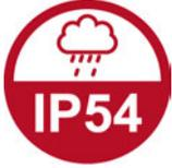
Schutzart des Geräts IP54 (Schutz gegen Staub und Spritzwasser)
